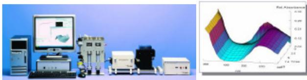
停流 (stopped flow) 光谱技术,用于研究溶液体系的毫秒级的快速反应动力学,反应的时间多在 0.001 秒到 秒时间量级,通过研究瞬时动力学现象可反映反应的速度、机理、短时间存在过的反应中间过渡态等基础信息。可选择配置的功能模块为: 二极管阵列检测、双荧光检测、荧光偏振检测,多通道序列混合系统、淬灭停流检测,及 CD 圆二色停流分析系统等。广泛应用于分子间相互作用的快速反应如自由基反应、蛋白质-蛋白质、蛋白质-配体的结合,蛋白质折叠、酶反应、各种协同作用及其它化学反应等。
